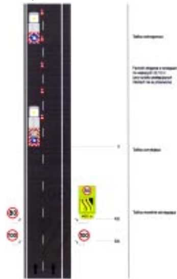
Rys. 11.10.2. Przykład oznakowania miejsca krótkotrwałych robót na lewym pasie jezdni jednokierunkowej
