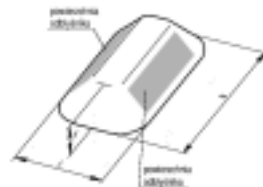
Rys. 6.1.1. Punktowy element odblaskowy pryzmatyczny
